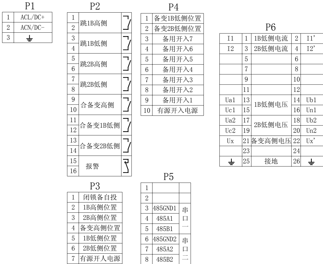
附图8.1 XZ-6162厂用变备自投装置背板端子图
